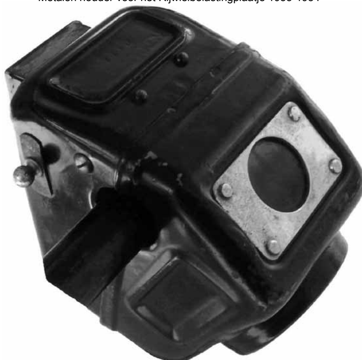
Ingenieus ... koplamp voor een fiets met geïntegreerde houder voor een rijwielbelastingplaatje. Aan de uitsparing te zien voor het belastingjaar 1935-1936. - Deze lamp ontbreekt nog in mijn collectie.
